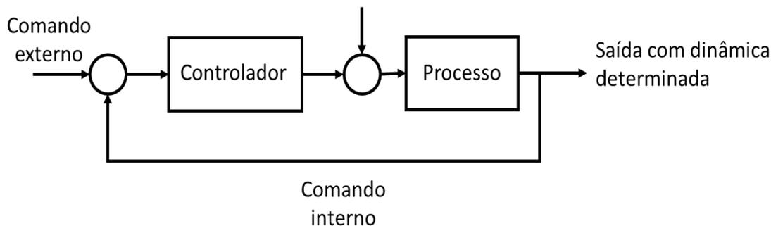
O controlador PID é uma função linear que apresenta uma parcela proporcional, uma integral e uma derivativa do valor fornecido como entrada. A saída do PID é da forma
