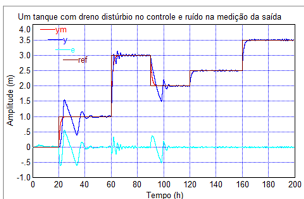
Figura 7 – Controle de nível do tanque 2.
